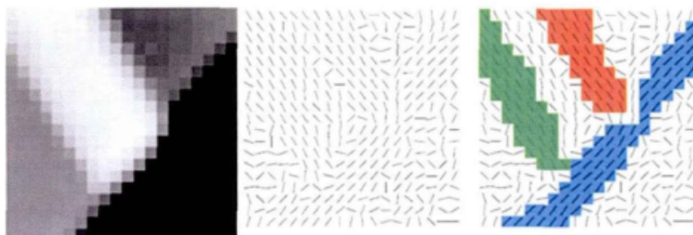
图 3.2 LSD 中线段检测过程 [40]
